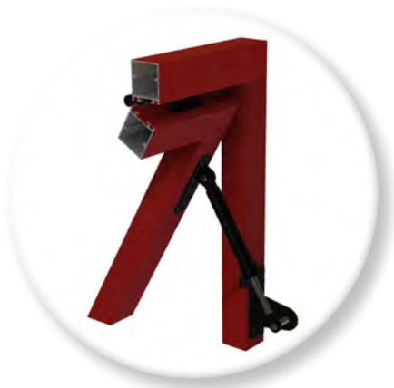
Detalle sección. Marco 40 x 45 y bastidor (40 x 45 en este caso).
